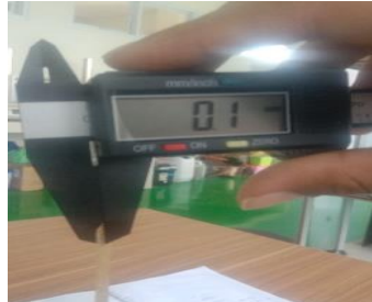
Pengukuran ketebalan Dengan jangka sorong
