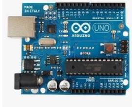
Gambar 2. 3 Arduino Uno<sup>[16]</sup>
