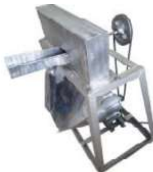
Gambar 2.3 Mesin pengiris tempe (Handoko et al., 2018)
