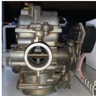
Gambar 4. 7 Jarak lebih dari 50 Throttle Body terbuka
