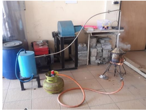
Karbonisasi sekam padi menggunakan alat pirolisis
