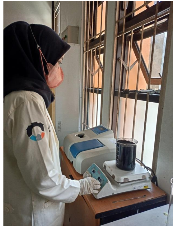
Proses aktivasi kimia karbon menggunakan \text{H}_3\text{PO}_4
