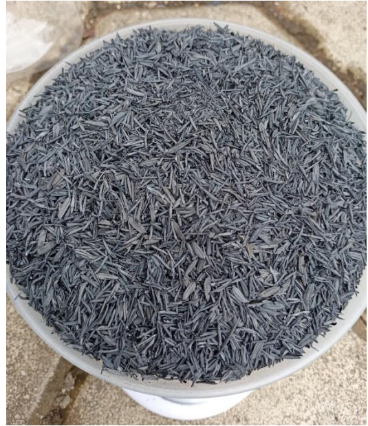
Hasil karbonisasi sekam padi pada suhu 348°C selama 1 jam
