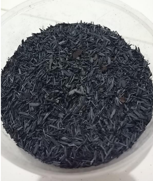
Hasil karbonisasi sekam padi pada suhu 300°C selama 1 jam
