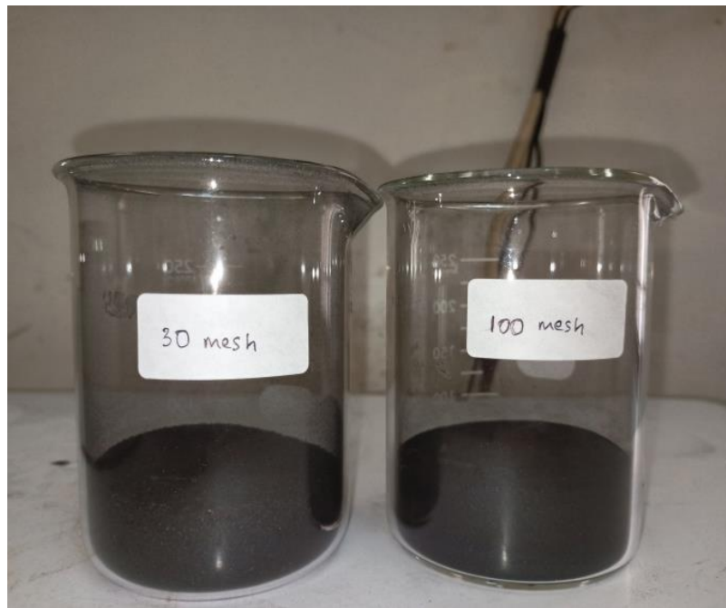
Perbandingan ukuran 30 mesh dengan 100 mesh
